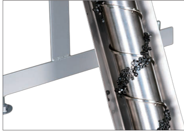
SCC・SC ワーク搬送
